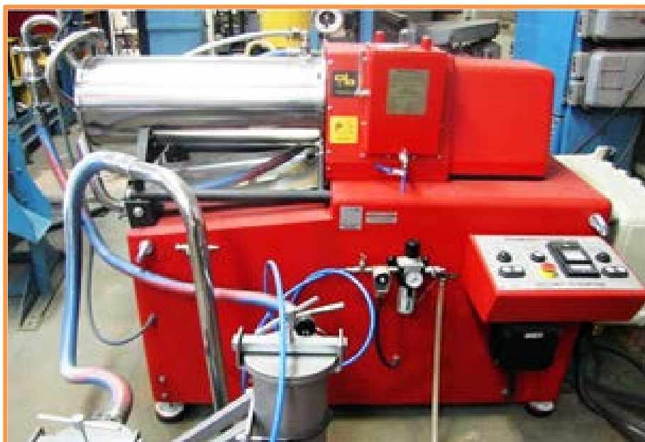
Рисунок 3. Общий вид бисерной мельнице ультратонкого измельчения Supermill, модель ENP.
