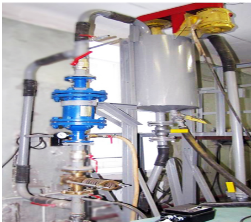
Рисунок 5. Роторно-пульсационный аппарат РПА.
