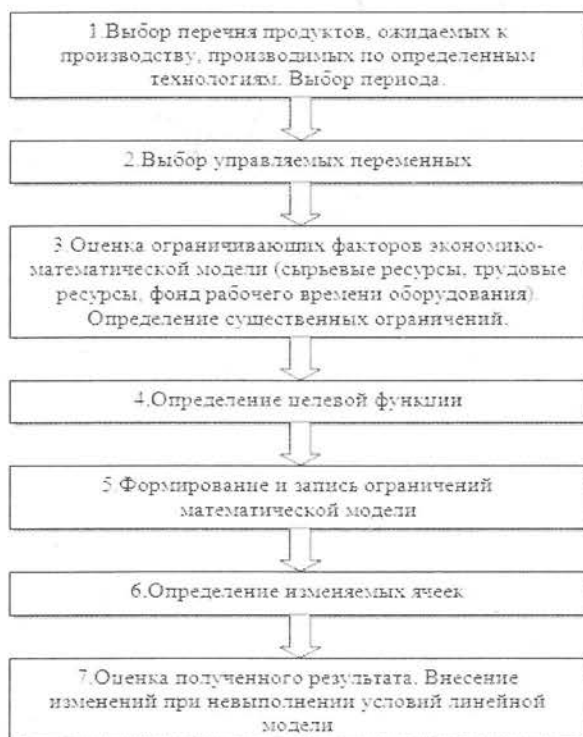
Рис. 2. Алгоритм построения экономико-математической модели формирования оптимального плана производства с выпуском ферросплавной продукции на основе РЗМ
