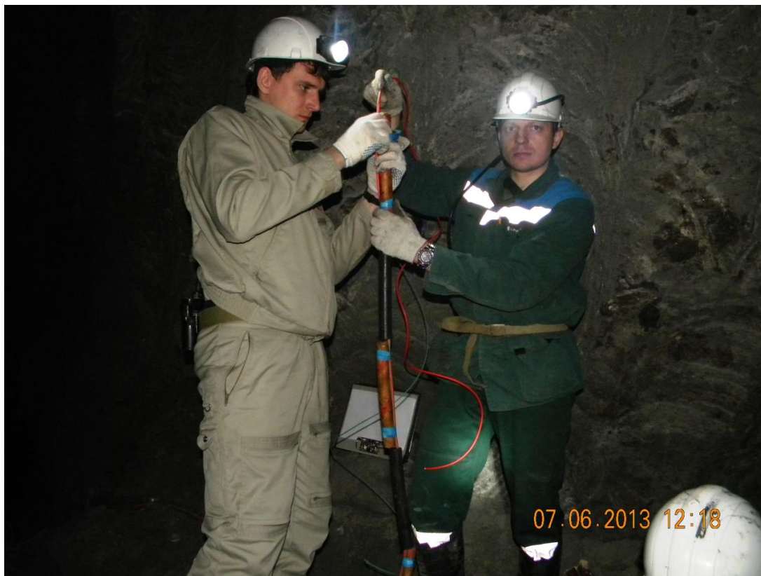
Рис. 9. Конструкция заряда с 3-мя патронами.
