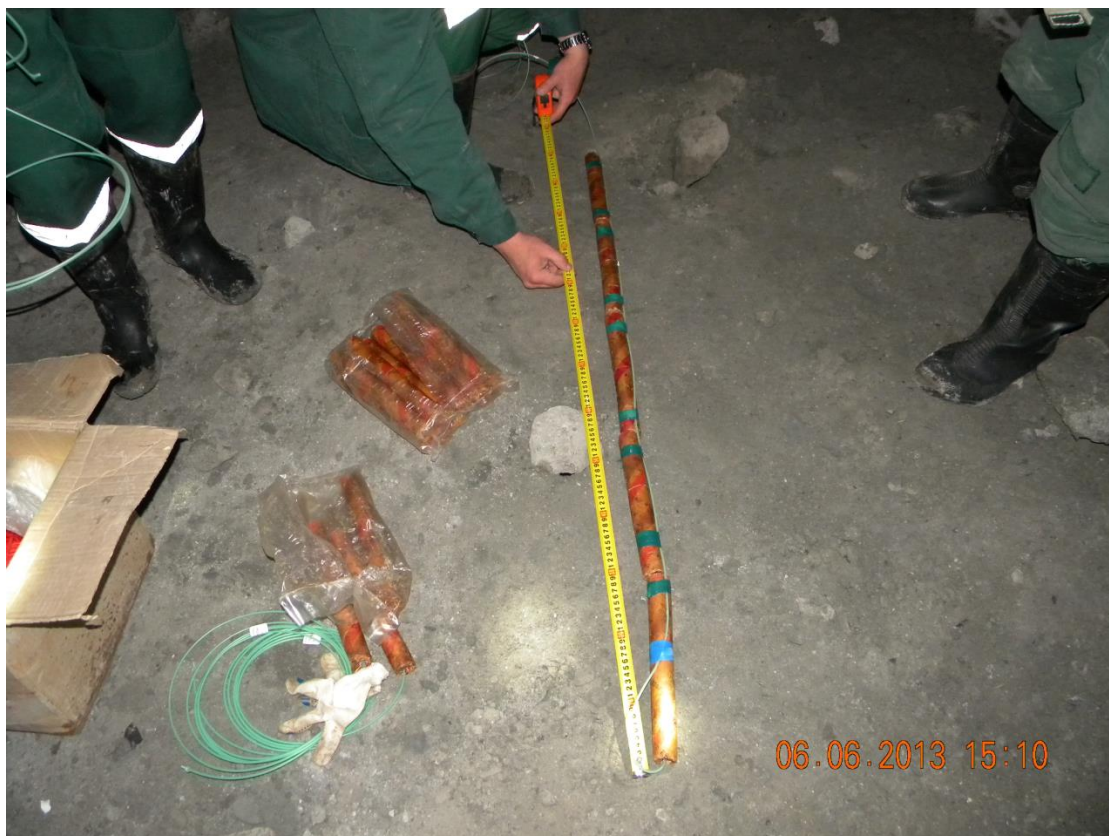
Рис. 4. Взрыв №1. Общий вид заряда в сборе.
