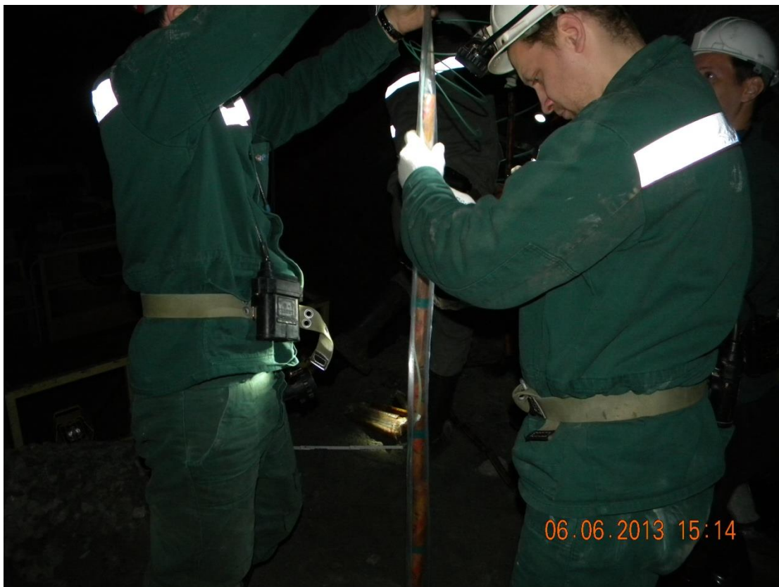
Рис. 5. Помещение заряда в полиэтиленовый рукав.
