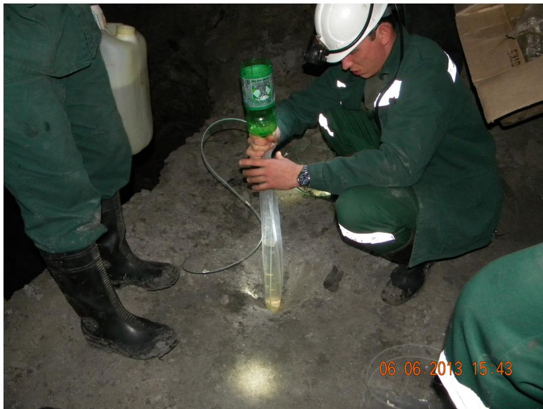
Рис. 7. Заливка воды в полиэтиленовые рукава.
