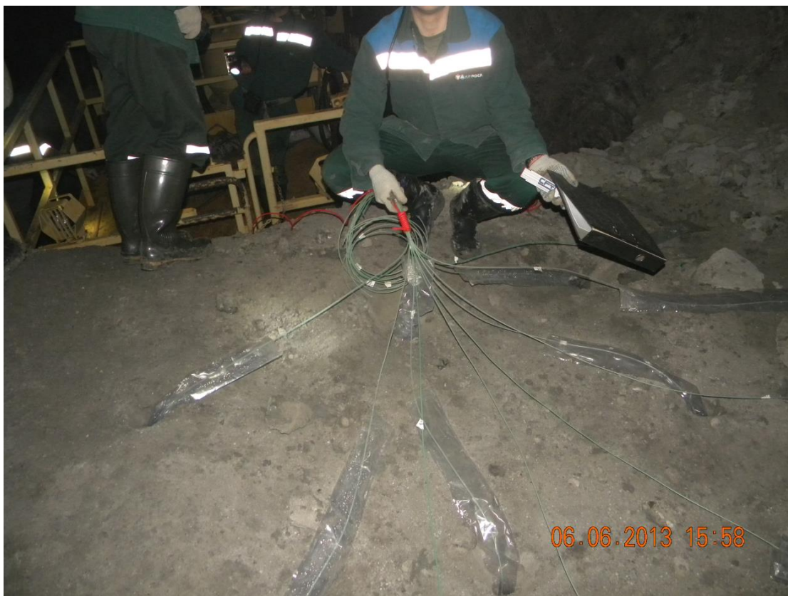
Рис. 8. Собранная взрывная сеть.
