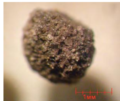
Рис. 3. Зерна кварца, связанные между собой гетит-гематитовой смесью. Просыпка, косой свет, без анализатора, 20°
