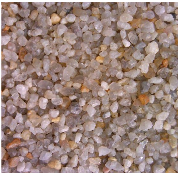
Рис. 1. Зерна кварца белое (слева) и бесцветное (справа). Просыпка, косой свет, без анализатора, 9°
