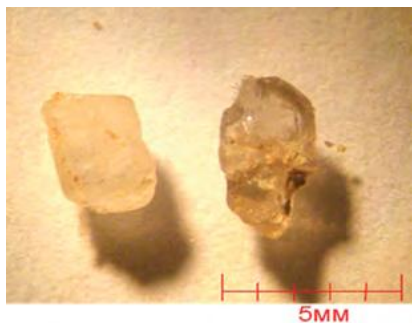
Рис. 1. Зерна кварца белое (слева) и бесцветное (справа). Просыпка, косой свет, без анализатора, 9°
