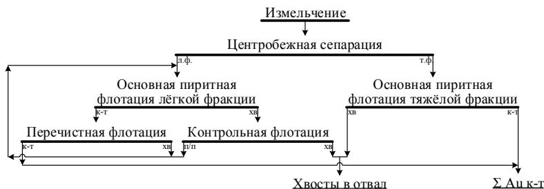
Рисунок 2 – Технологическая схема гравитационно-флотационного обогащения углисто-глинистых сланцев
