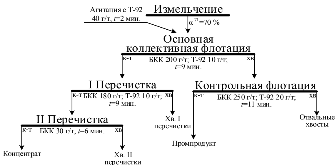
Рисунок 4 – Рекомендуемая схема обогащения углисто-глинистых сланцев месторождения Каменское
