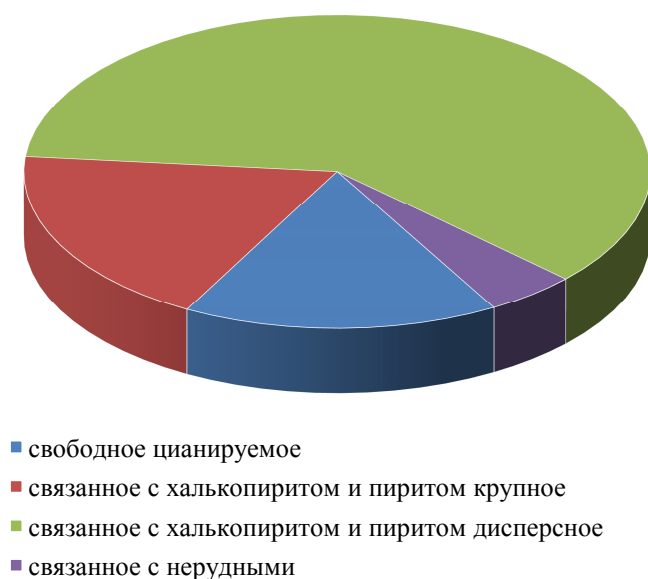
Рисунок 1 - Формы проявления золота в исходной пробе руды
