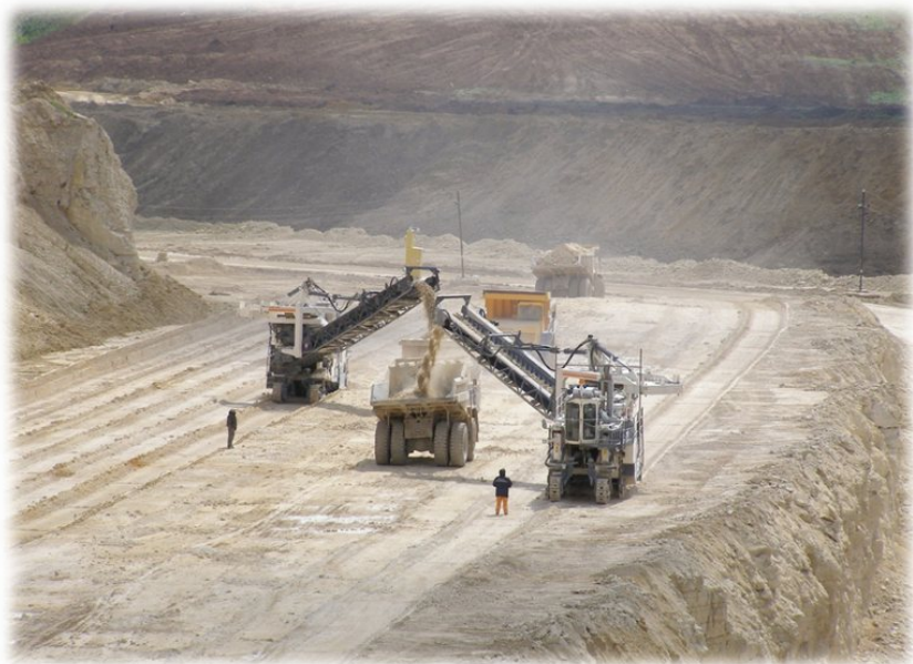
Рис. 3. Работа фрезерных комбайнов с погрузкой в автосамосвалы
