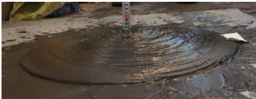
Рис. 4. Конус пульпы, полученной из хвостов Учалинского ГОКа с применением флокулянта
