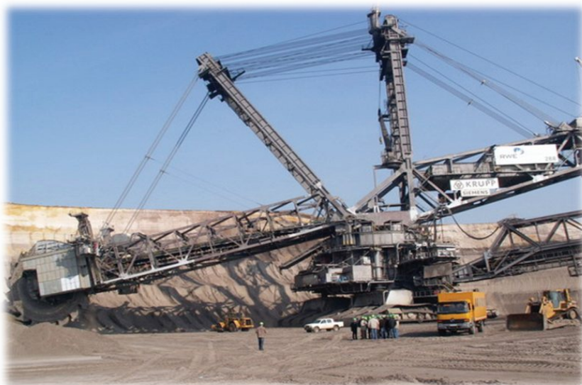
Рис. 2. Работа роторного экскаватора с верхним черпанием
