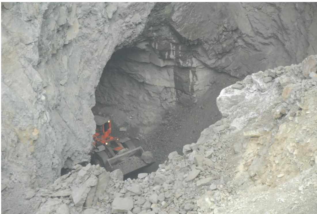
Рис. 10. Отгрузка руды с помощью ПДМ с дистанционным управлением (этап 2).
