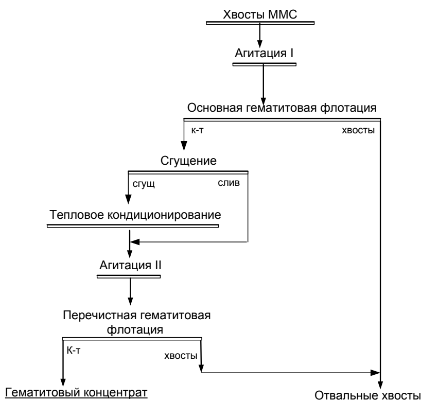
Рисунок 1 - Схема флотационного обогащения хвостов ММС
