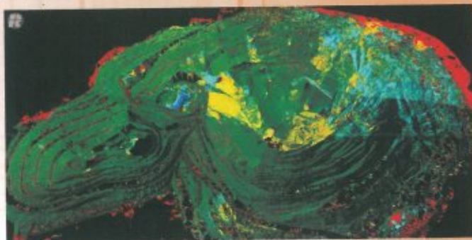
Рис. 2. Трехмерная модель карьера, построенная по результатам сканирования
