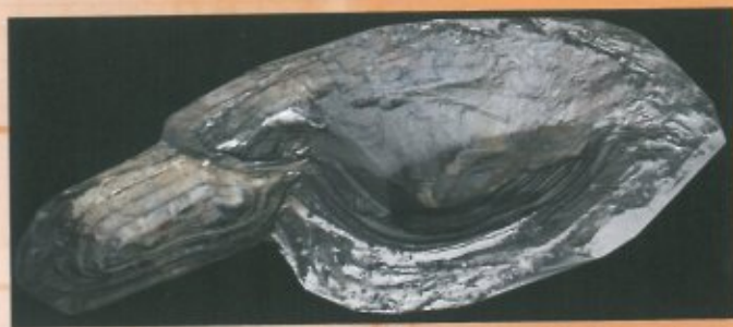
Рис. 2. Трехмерная модель карьера, построенная по результатам сканирования
