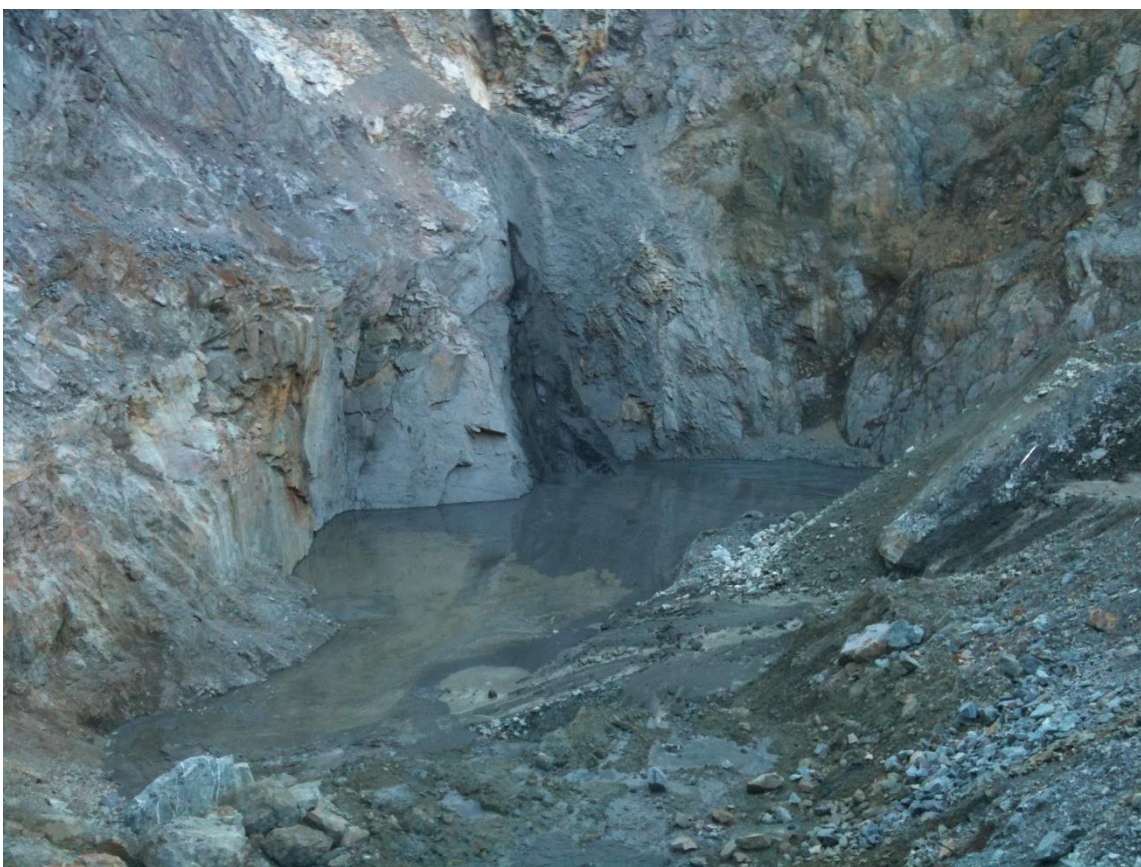
Рис. 7. Закладка выработанного пространства после выемки придонных запасов разделительного целика.
