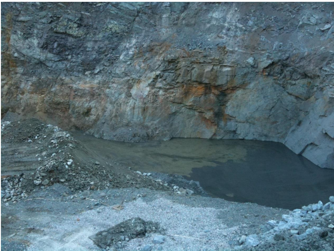
Рис. 5. Закладка выработанного пространства после выемки придонных запасов разделительного целика (камера К1ПЦС1-240).
